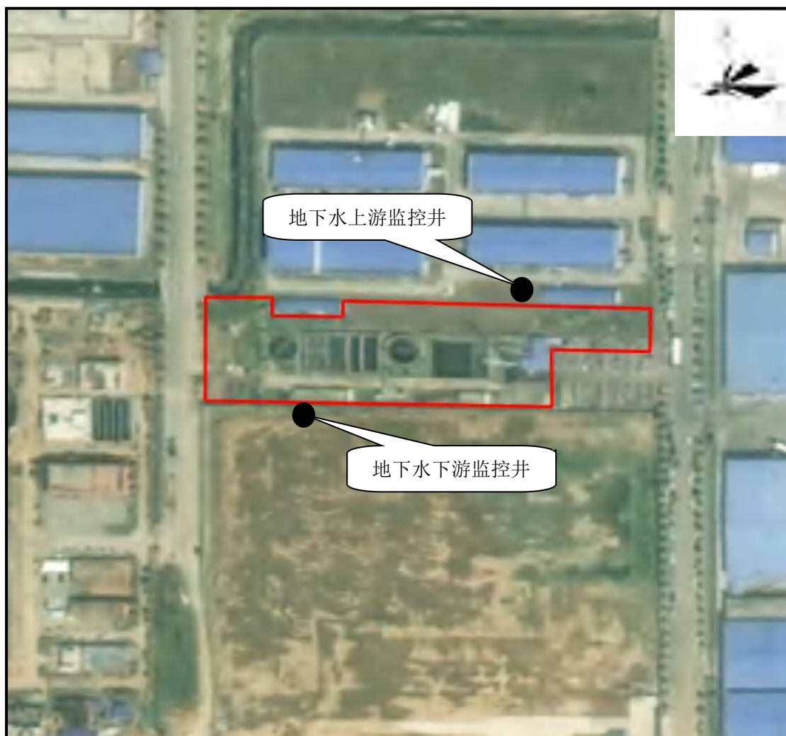
图 5.2-16 地下水监控井分布示意图
